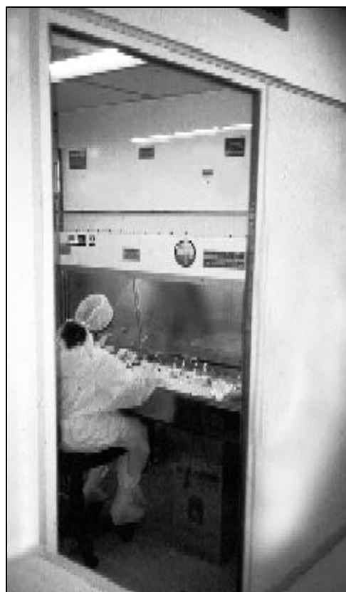
Operario realizando una mezcla intravenosa en una cabina de flujo laminar
